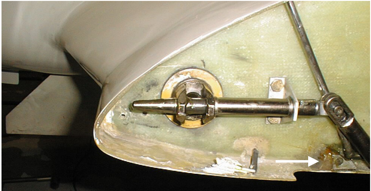
Abbildung 1: Bolzen komplett eingeschoben, kann jedoch, durch eingelaufenen Anschlag F1-1300, von Hand zurückgeschoben werden.
